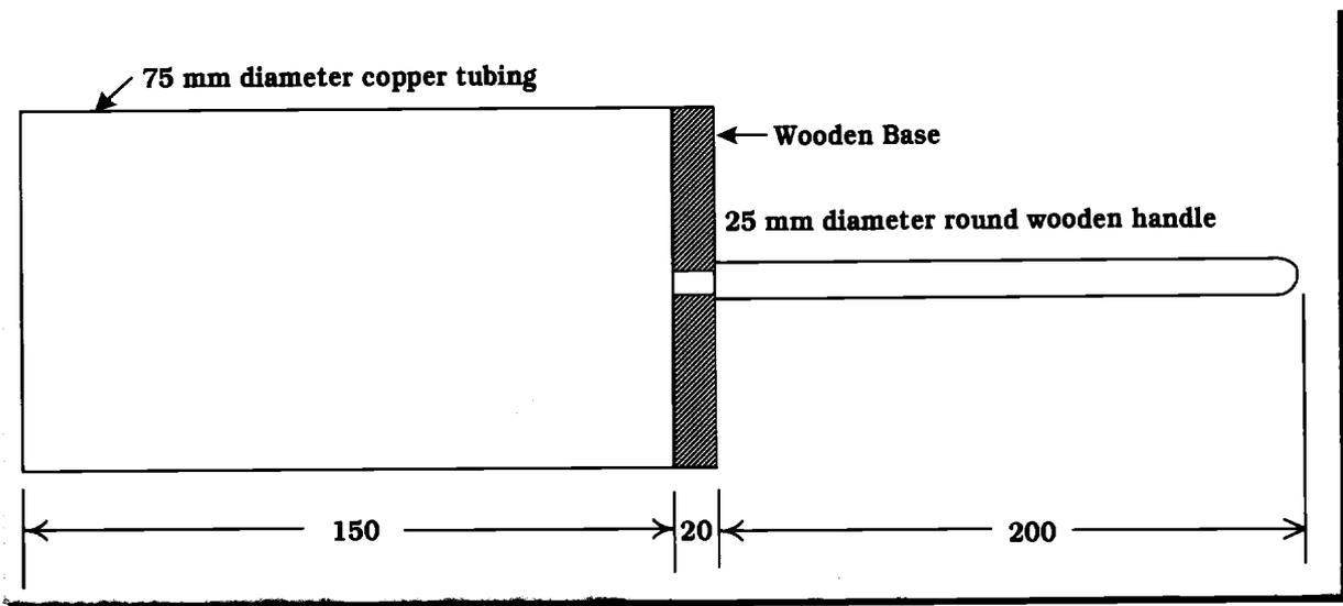
FIGURE 14: MUDBALL SAMPLER
