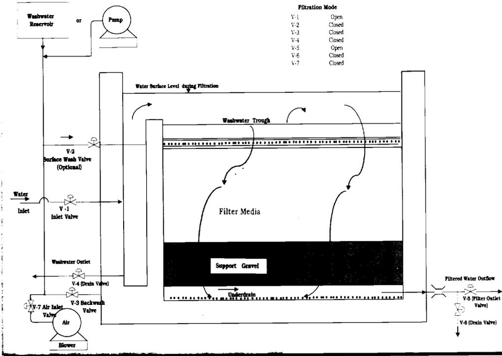
FIGURE 12: FILTRATION MODE OF OPERATION
